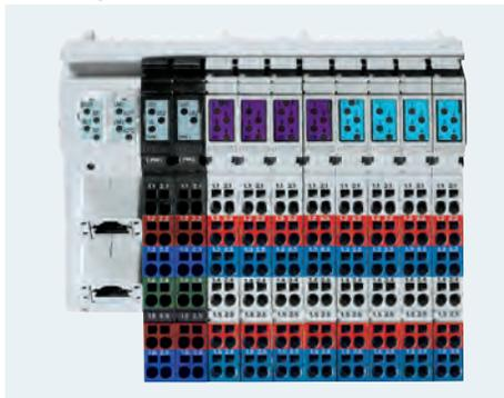
Digitale E/A-Block I/O-Module – lassen sich durch den integrierten Buskoppler in alle gängigen Feldbusssysteme einbinden. Das fertige Modul minimiert gegenüber modularen Stationen die Kosten und ist die ideale Lösung zum Einbau in kompakte Schaltschränke.
