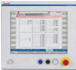
Die IndraControl V-Bedienterminals kombinieren flache Bediendisplays oder Embedded-PCs mit industrietauglichen Gehäusen zu einer robusten Einheit. Die Bedienung der IP54-geschützten Terminals (frontseitig IP65) erfolgt über TFT-Touchscreen, drei Funktions- und einen Not-Halt-Taster. Das einschalige Metallgehäuse mit ergonomischen Griffmulden und Halterungen nach VESA-Standard ermöglichen den bedien- und servicefreundlichen Einsatz direkt an der Maschine.
