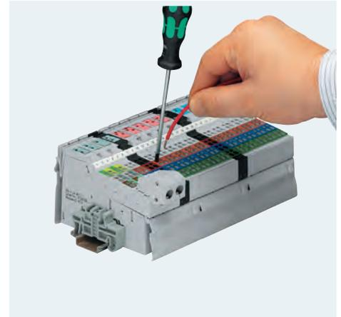
Die abisolierten Leiter werden einfach ohne Aderendhülsen in die Zugfederklemmen der Inline-Stecker eingeführt. Dabei sind Anschlussquerschnitte im Bereich von 0,2 mm<sup>2</sup> bis 1,5 mm<sup>2</sup> möglich.
