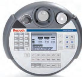
Bedienen, Einrichten, Parametrieren und Diagnostizieren, ganz gleich von welchem Ort – IndraControl VCH 08 macht es über Ethernet TCP/IP möglich. Beim Anschließen und Abstecken wird die Stopp-Funktion automatisch überbrückt und gewährleistet störungsfreies Arbeiten. Niedriges Gewicht und optimales Design ermöglichen ermüdungsfreies Arbeiten und hohen Bedienkomfort. Der integrierte 3-stufige Zustimmenschalter und der 2-kreisig ausgeführte Stopp-Taster sorgen für maximale Sicherheit.
